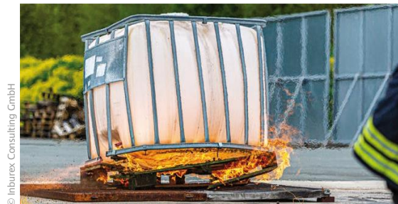
Abblasvorgang eines Kunststoff-IBC mit 5 l Restmenge an Aceton.
